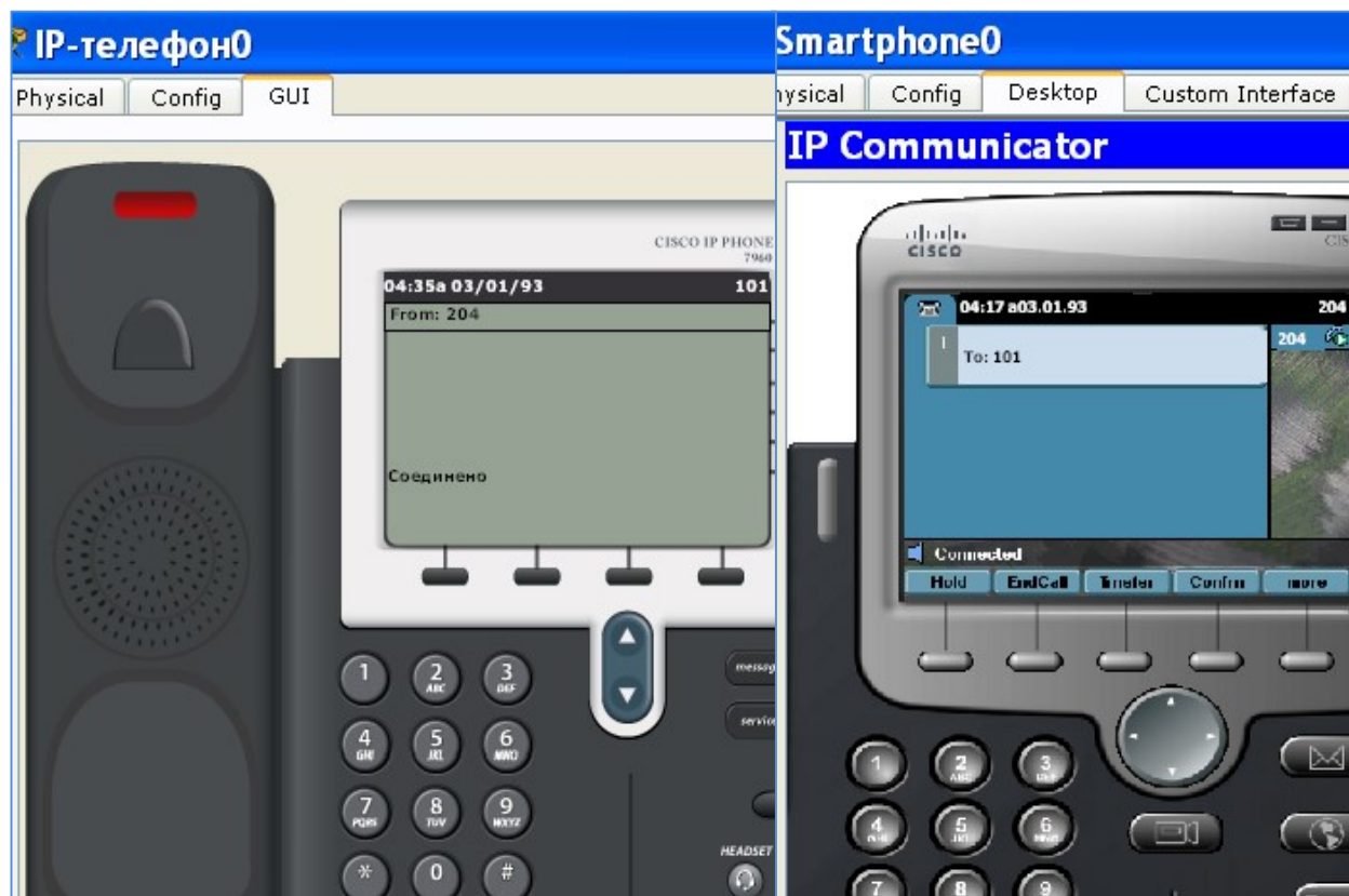
Рисунок 2 – Встановлення з'єднання між Smartphone0 та IP-телефон0 Figure 2 – Establishing a connection between Smartphone0 and IP-Telephone0
