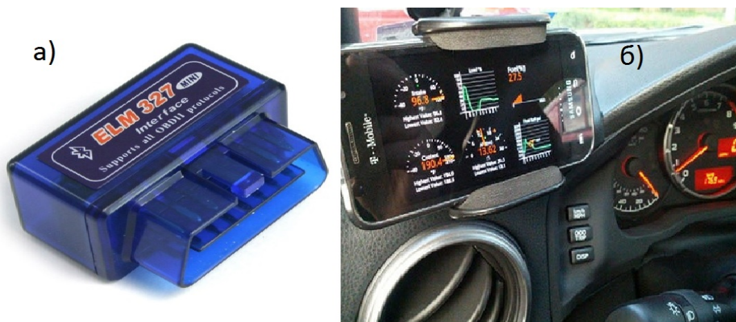
Рисунок 3 – Приклад сучасної системи самодіагностування: а) автосканер; б) мобільний пристрій.
