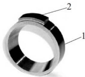
Rysunek 1 – Badana para cierna (1 – próbka pierścieniowa, 2 – przeciwpróbka)
