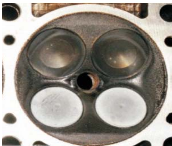
Rys.6. Osady utworzone w komorze spalania [3]
