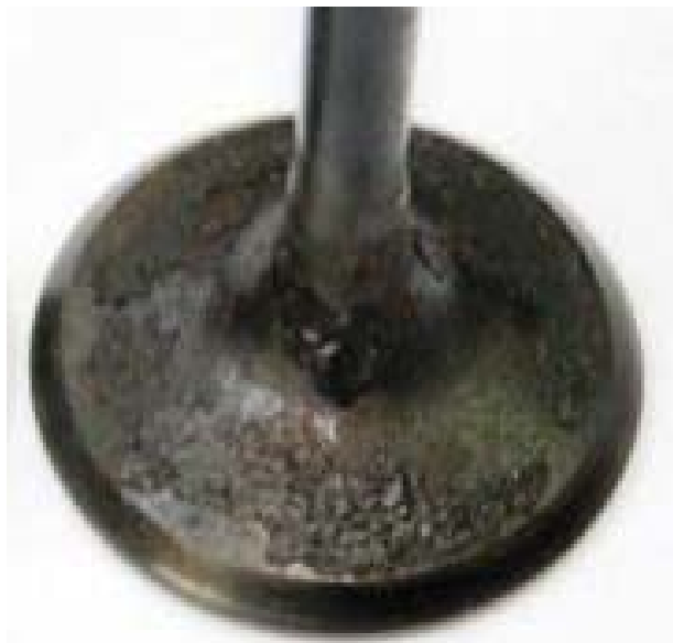
Rys.3. Osady utworzone na zaworze dolotowym [3]
