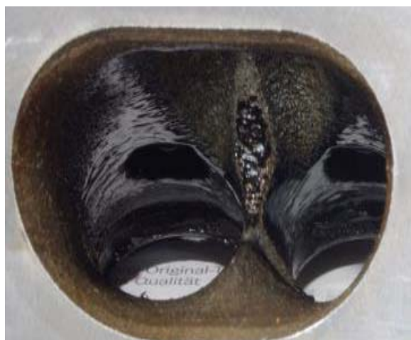
Rys.4. Osady utworzone w układzie dolotowym [3]
