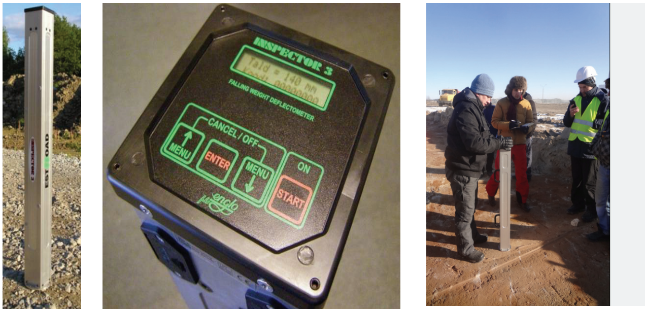
Рисунок 2 – Прилад для визначення динамічного модуля пружності Inspector 3
