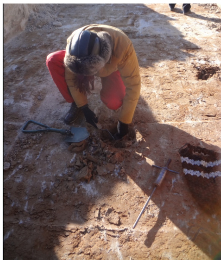
Рисунок 3 – Відбір ґрунту «ріжучим кільцем» з подальшим визначенням щільності та вологості
