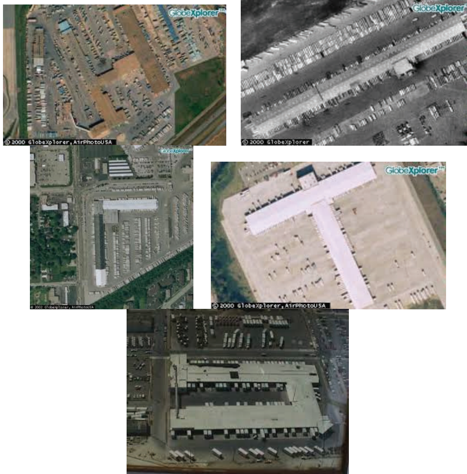
Рисунок 1 – Конфігурації складів крос-докінгу Н, І, L, Т, U
