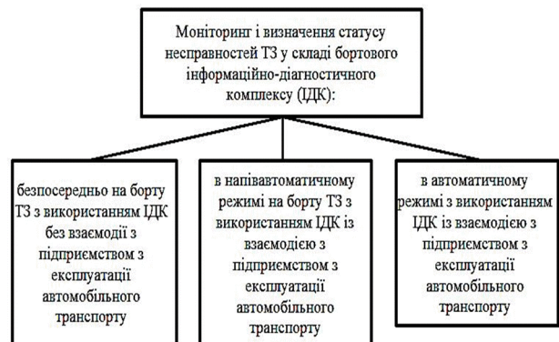
Рис 2. Варіанти моніторингу і визначення статусу несправностей ТЗ у складі бортового інформаційно-діагностичного комплексу
