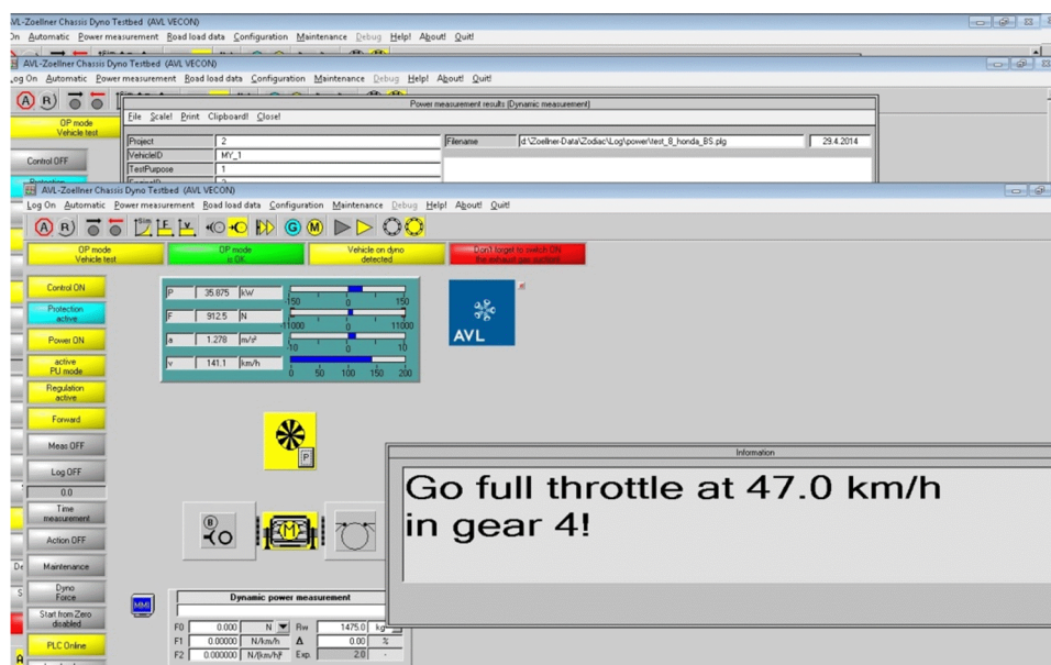
Rys. 3. Widok okna programu do sterowania pracą hamowni podwoziowej – zwiększanie prędkości jazdy do prędkości początkowej testu
