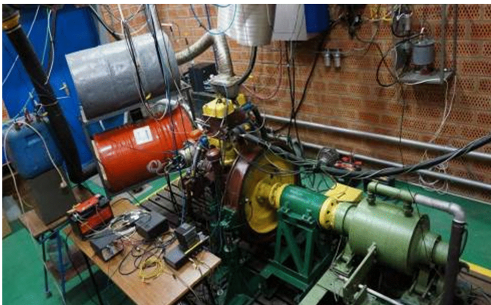
Rys. 3. Obiekt badań – jednocylindrowy silnik badawczy SB-3.1 wyposażony w układ zasilania typu CR [9]
