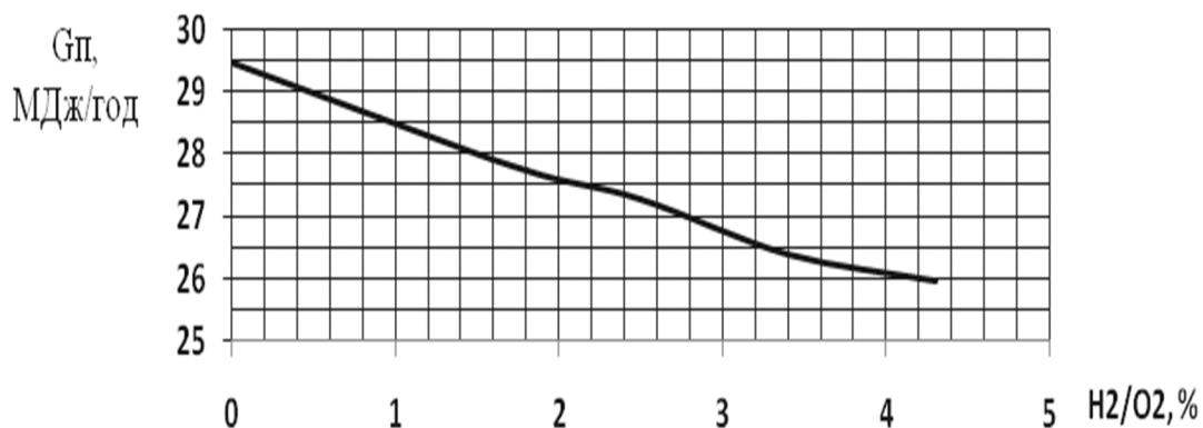
Рисунок 3. Витрата палива в тепловому еквіваленті при додаванні газу H_2/O_2 ( n=900 \text{ хв}^{-1} )
