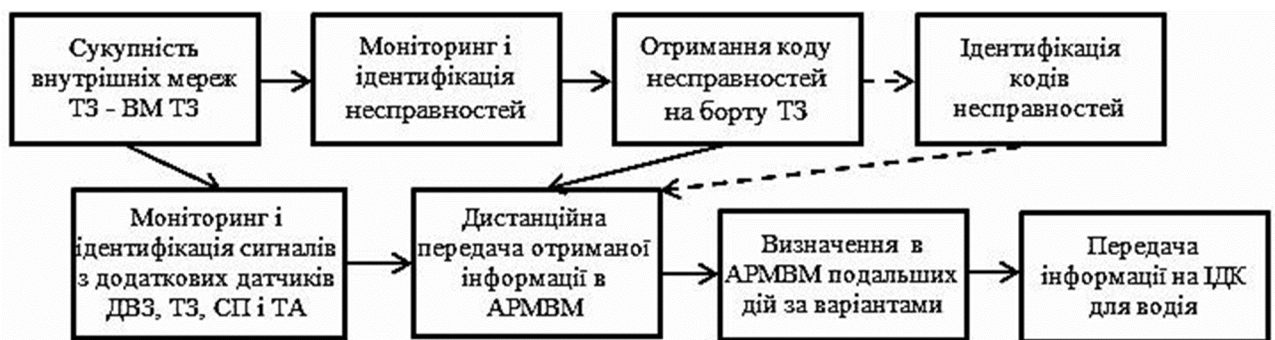
Рис. 5. Блок-схема моніторингу і визначення статусу несправностей в автоматичному варіанті з використанням ІДК
