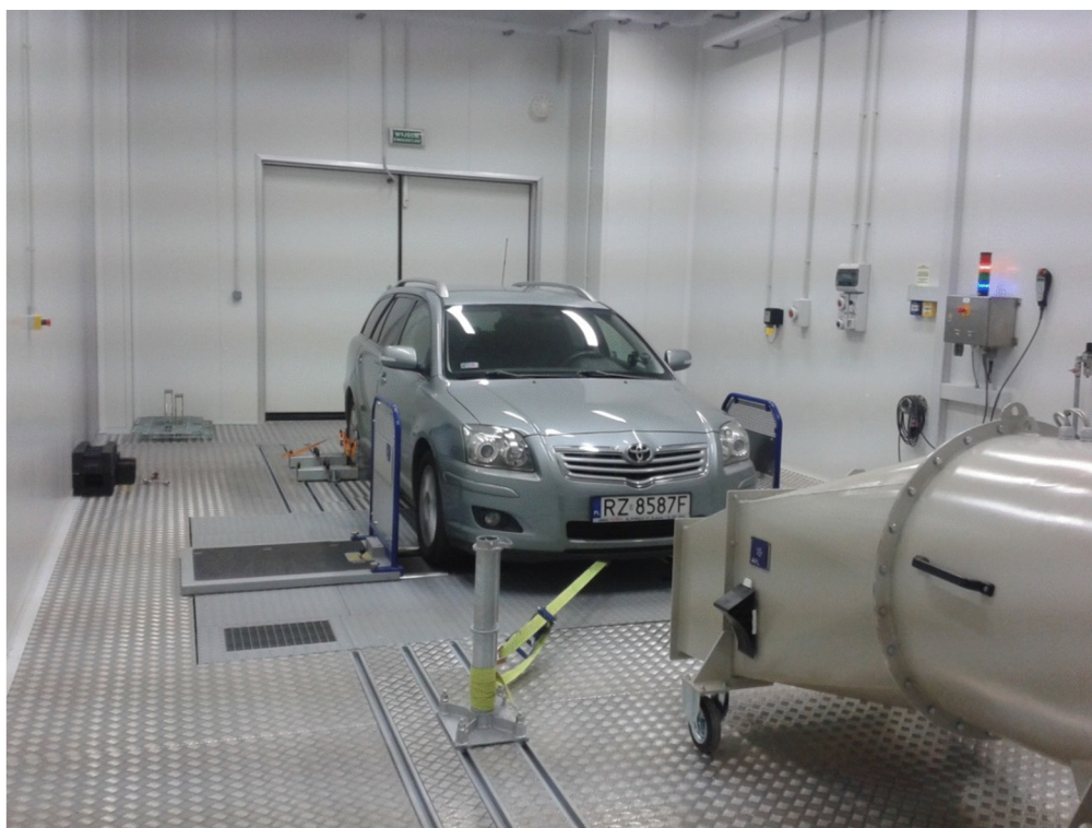
Rys. 1. Widok samochodu na stanowisku hamowni podwoziowej z wentylatorem chłodzącym umieszczonym przed samochodem
