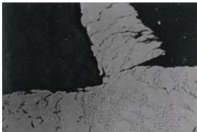
Рисунок 3. – Мікроструктура (х 300) зони стружкоутворення при вільному ортогональному різанні чавуну СЧ15 (HB 175): v = 0,08 м/с; S = 0,05 мм; різець – сталь Р6М5; \gamma = 15^\circ ; \rho = 0,008 мм; \xi = 2,7 ; без МОР
