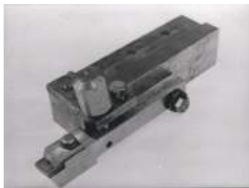
Рисунок 2. – Різець, що падає, для досліджень зони стружкоутворення
