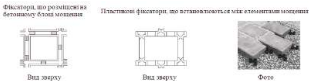
Рисунок 6. – Влаштування швів в водопроникних брукованих покриттях
