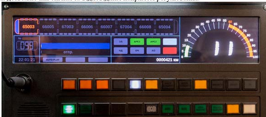
Рисунок 6 – Пульт керування машиніста метрополітену з системою АЛС-АРШ [15]
