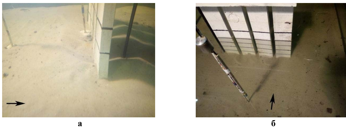
Рисунок 3 – Розмив і намив піщаного ґрунту поблизу моделі проникного хвилелому:
