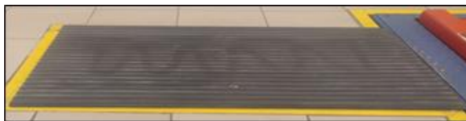
Rysunek 1 – Tester zbieżności Figure 1 – Side-slip tester
