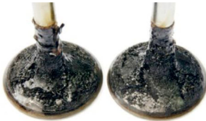
Rysunek 4 – Osady na zaworach dolotowych[5]
