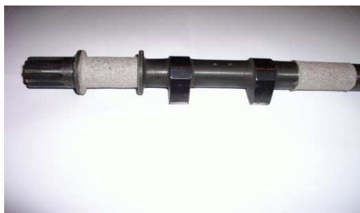
Рисунок 3 – Розподільний вал 14-04-20-1 двигуна Д-160.111-1 з покриттям і після обробки Figure 3 – Camshaft 14-04-20-1 of the D-160.111-1 engine with a covering and after processing
