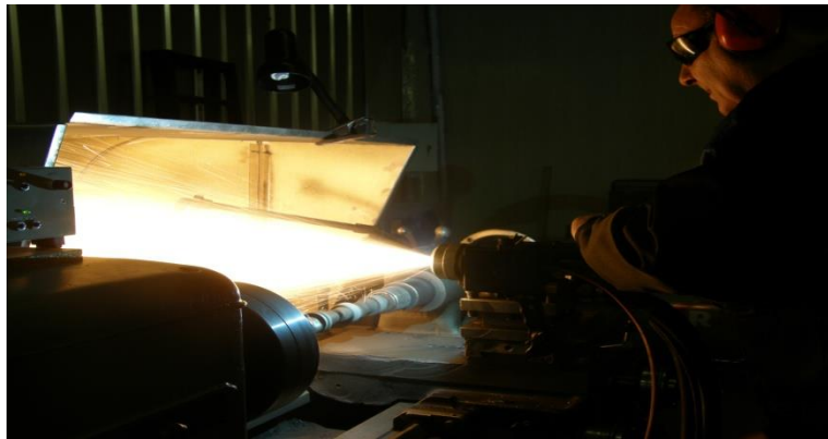
Рисунок 2 – Процес нанесення покриттів на розподільний вал методом ЕДН Figure 2 – The process of coating the camshaft by EDN
