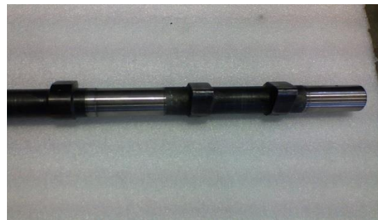
Рисунок 3 – Розподільний вал 14-04-20-1 двигуна Д-160.111-1 з покриттям і після обробки Figure 3 – Camshaft 14-04-20-1 of the D-160.111-1 engine with a covering and after processing
